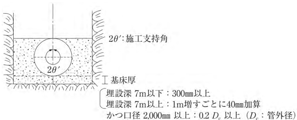
38 図-4.6.8 岩盤の場合の基礎工 39
