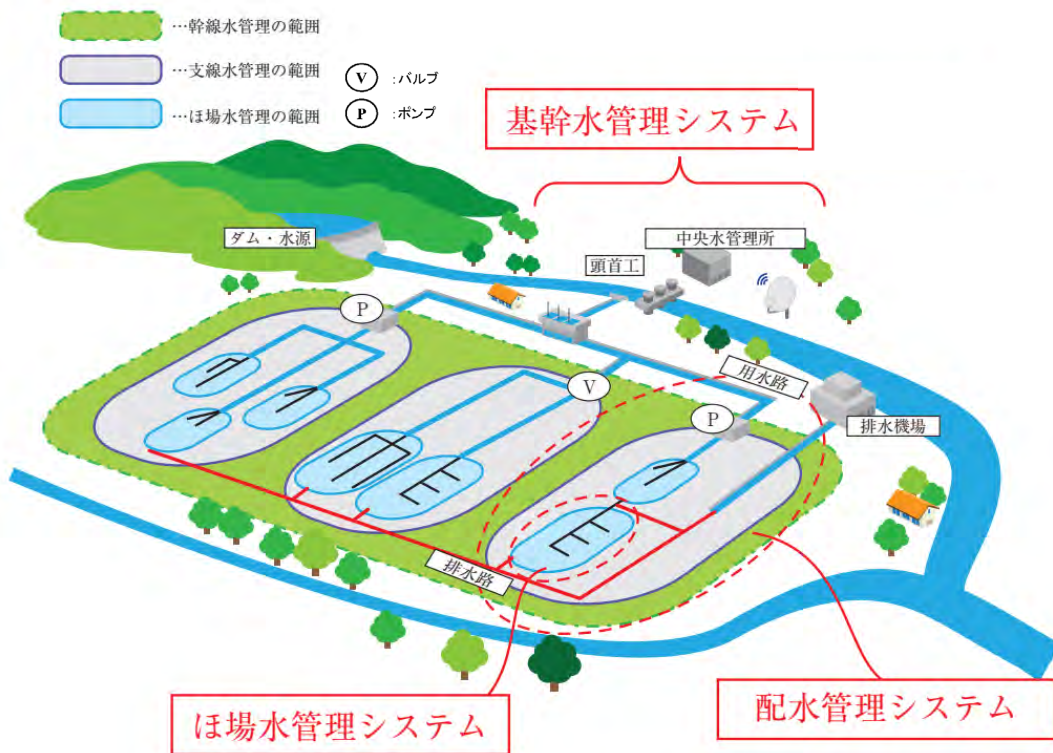
12 図-4.10.1 次世代型水管理システムの概念図 1)
