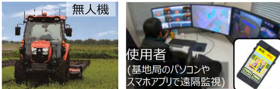
21 22 図-4.11.2 ローカル 5G を利用した遠隔監視による自動走行農機の導入事例 2) 23
