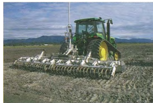
19 写真-5.4.1 運土量削減型整地工法による作業状況（左：表土と下層土の反転、右：運土・整地）
