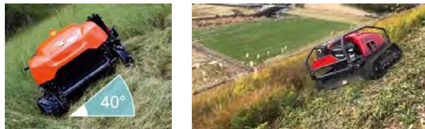
傾斜地でも使用可能な無線遠隔操作草刈機の事例
