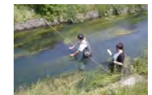
流速観測状況
