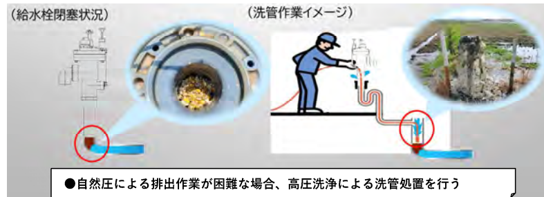
高圧洗浄による洗管処置のイメージ
