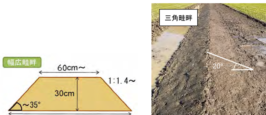
図-4.3.10 リモコン草刈機に対応した畦畔断面 4)
