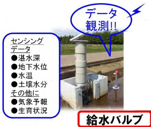
図-3.6.12 多機能型自動給水栓の例 7)
