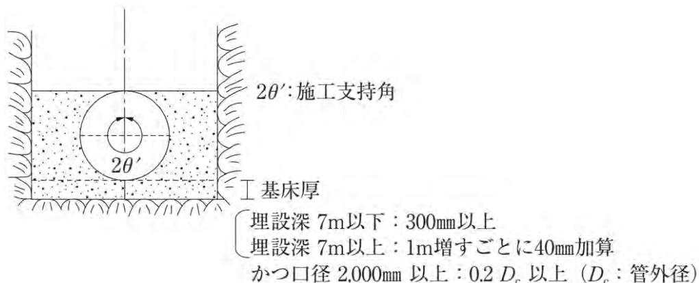
図-3.6.8 岩盤の場合の基礎工
