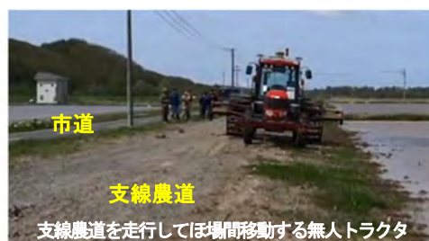
図-3.4.11 農業機械の接触事故防止を考慮した支線農道の整備事例 6)
