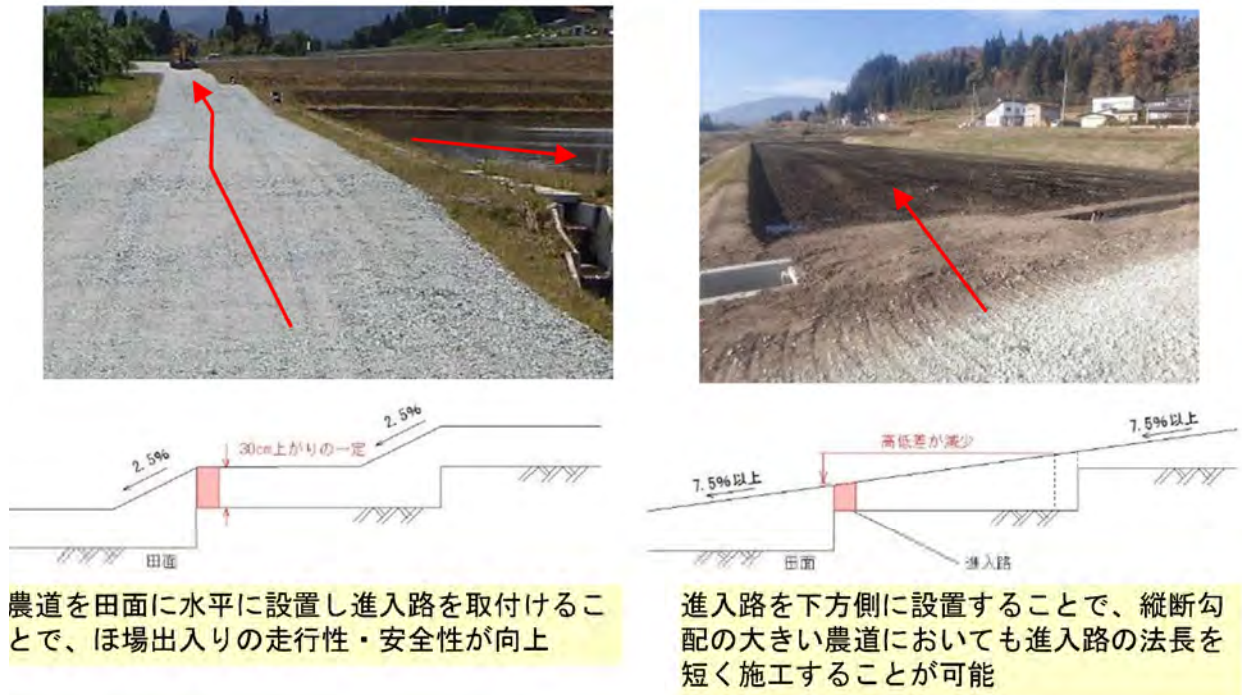
7 8 図-3.4.12 農道の路面高、進入路の位置の事例
