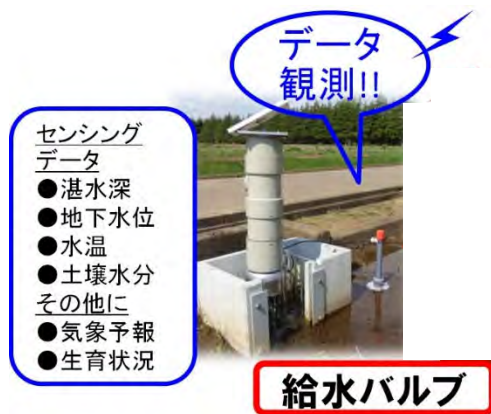
図-4.6.12 多機能型自動給水栓の例 7)
