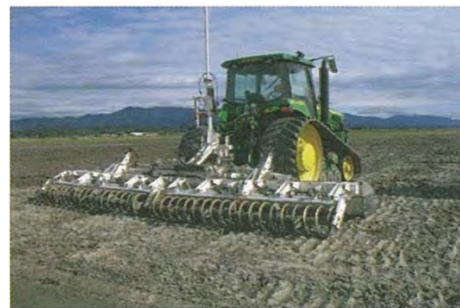
写真-5.4.1 運土量削減型整地工法による作業状況（左：表土と下層土の反転、右：運土・整地）
