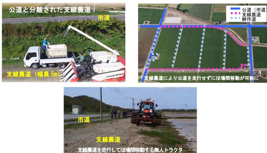
図-4.4.9 農業機械の接触事故防止を考慮した支線農道の整備事例 6)
