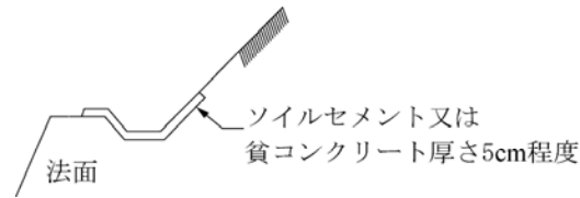
図-8.5.7 ソイルセメント排水溝
