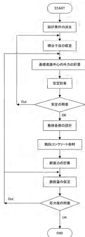
図-9.1.25 逆T式橋台の設計手順
