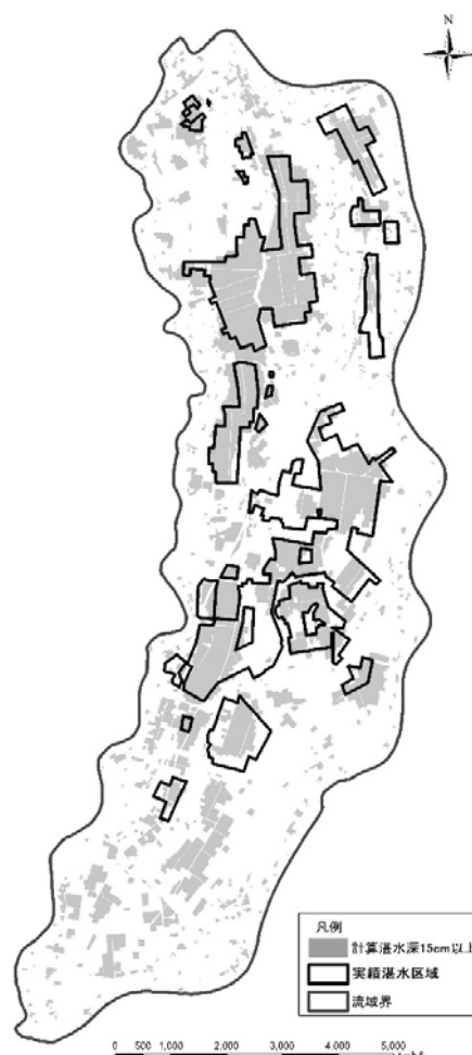
図-17.10 平成 23 年 7 月出水湛水区域比較
