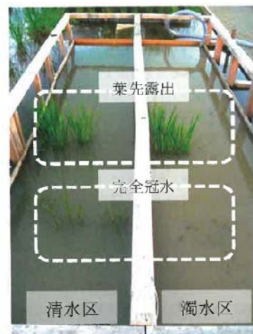
図-5.5 冠水試験中の様子 (手前が最深部)
