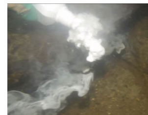
吸い込み (トレーサー試験の状況)
