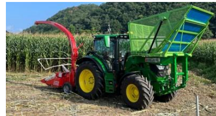
オートトラクタ。写真はハーベスタを装着した例。
