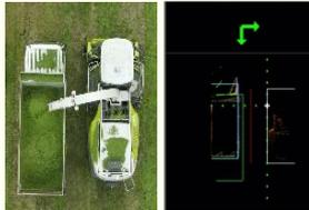
3D-LiDARによる位置の計測
