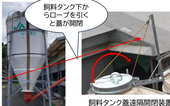
飼料タンク蓋遠隔開閉装置
