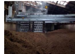
スクープ式攪拌発酵機
