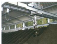
フジキ式スクリーン 攪拌発酵機
