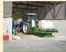
▲フレコンラップ法による 粳米サイレージ調製
