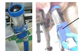
(乳頭洗浄機)乳房炎に悩まされていた農家では、新規発症が約半分になった例も。
