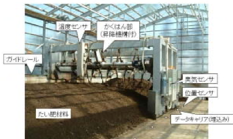
品質管理型たい肥自動混合・かくはん装置の概要 （全長 3,200mm、全高 3,240mm、全幅 6,140mm、質量 5,500kg）
