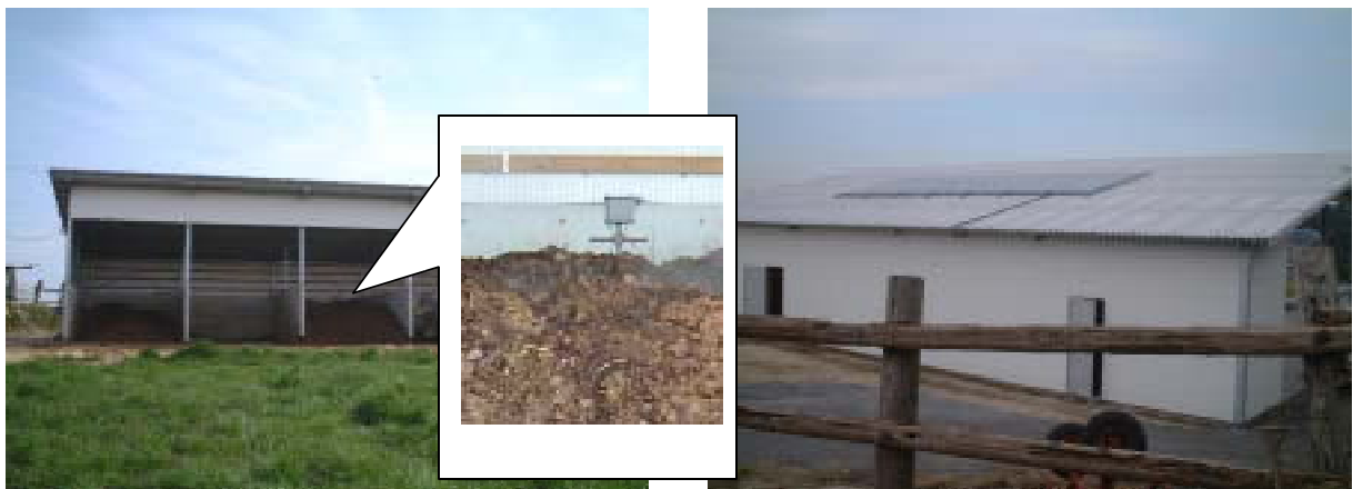
通気型発酵槽（4m×6m×4槽）に設置した マルチサーモプローブ（多点温度測定器）
