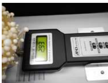
④ゆっくり1cm株へ押し込んだ時の最大圧縮力を測定する
