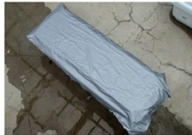
b) 遮光用のビニールで被覆したところ
