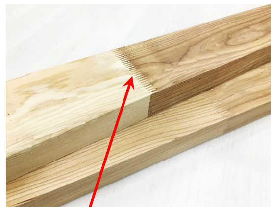
フィンガージョイント部 (たて継ぎ部)
