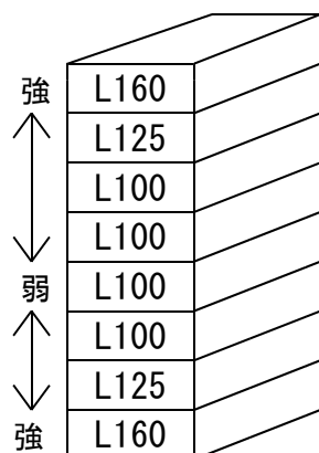
異等級構成構造用集成材 (対称構成)
