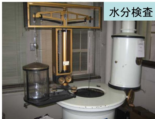
140°Cの熱風で乾燥し、生糸の水分を求めます。
