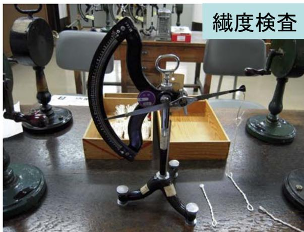
織度糸(112.5m)を400本作成し、生糸の太さのバラツキを検査します。
