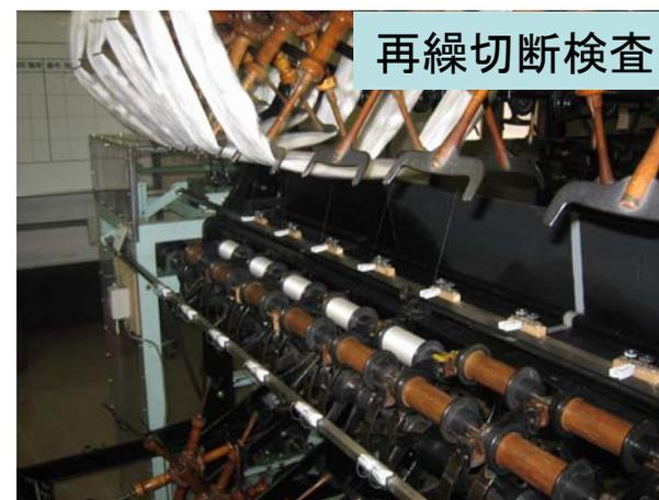
生糸の再繰作業130分間における切断回数を調べます。
