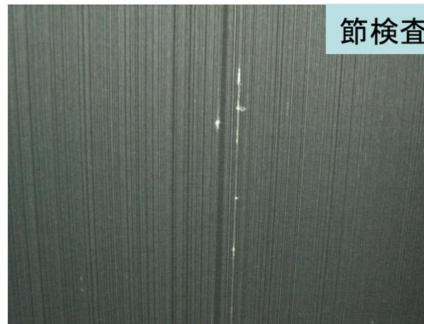
生糸をパルに巻き取り、現れた節の種類と数を検査します。
