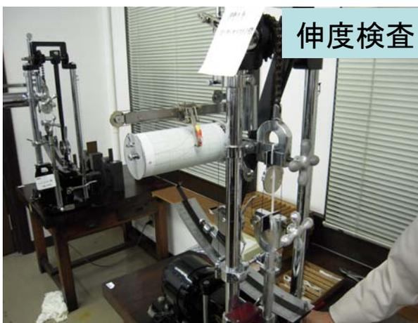
スターセリグラフで生糸が切断までどれだけ伸びるかを検査します。
