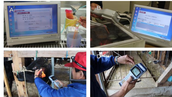
A. 精液製造時の読み取り登録の様子 B. 精液流通時の読み取りの様子 C. 人工授精時に、ハンディターミナルで雌牛の耳標バーコードを読み取っている様子 D. 人工授精時に、使用済み精液ストローのICタグを読み取っている様子
