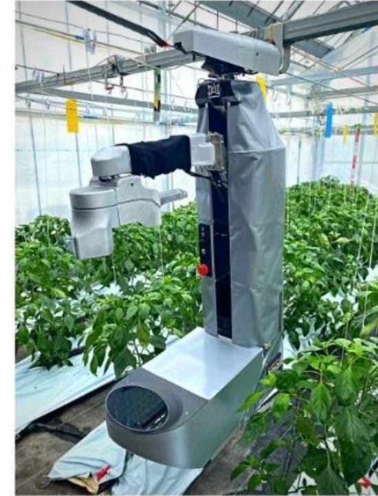
ピーマンAI自動収穫ロボット
