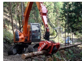
材の枝払い、玉切り等を連続して行う高性能林業機械
