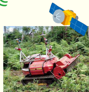
衛星測位による自動運転下刈り機械
