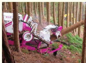
遠隔操作伐倒機械
