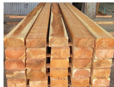
スギ大径材を活用した 横架材の製造技術の開発
