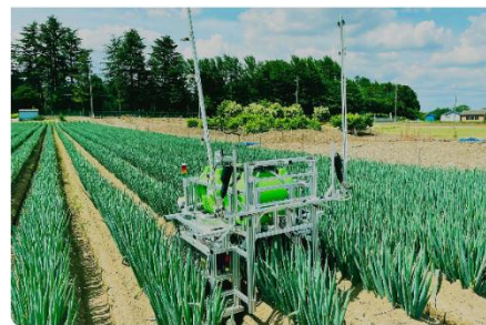
ねぎの自動農薬散布ロボット
