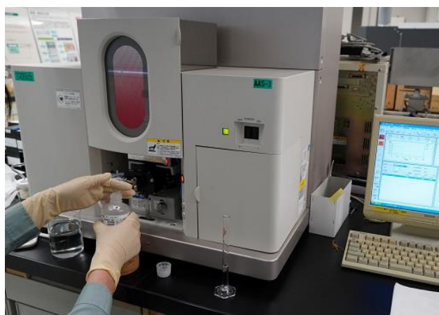
原子吸光による肥料成分の測定
