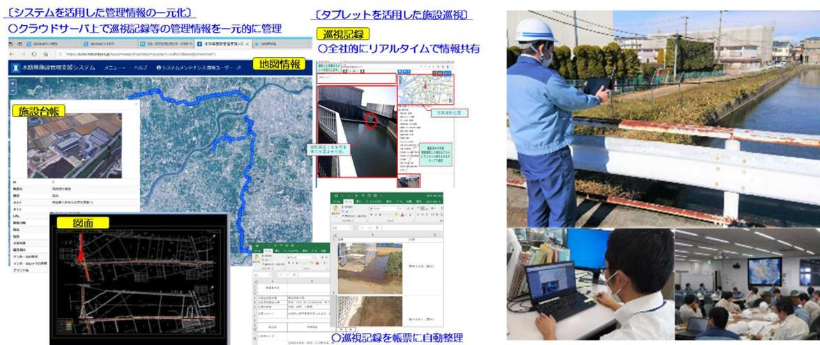
図-4 水路等施設管理支援システム（左図）及びシステムを活用した巡視点検・訓練状況（右図）
