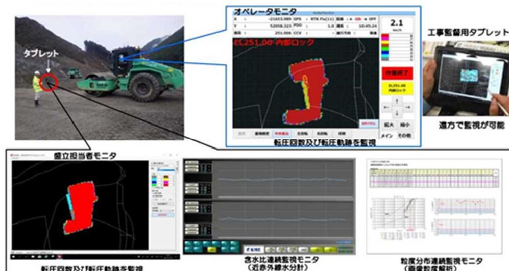
図-2 施工状況のリアルタイム監視
