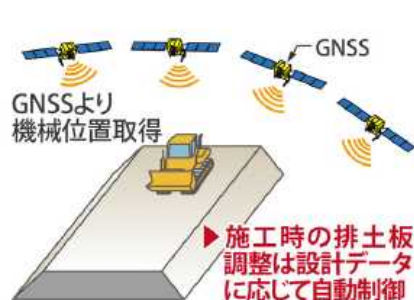
写真-1 GNSSを用いた盛立(層厚)管理
