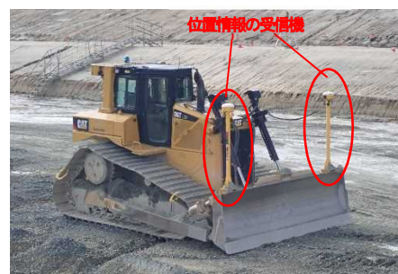
写真-1 GNSSを用いた盛立(層厚)管理
