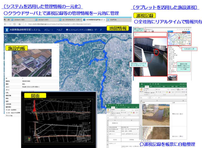
図-6 水路等施設管理支援システム（左図）及びシステムを活用した点検巡視・訓練状況（右図）
