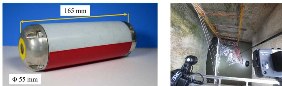
写真-3 木曾川用水(木曾川右岸施設)(左:漏水探査ロボット、右:漏水探査ロボット回収状況)
