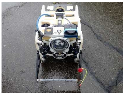
写真-1 水中ドローンによる不断水調査状況（愛知用水）
