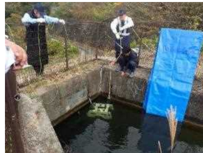
写真-1 水中ドローンによる不断水調査状況（愛知用水）
