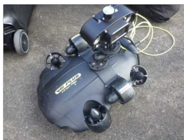
写真-1 水中ドローンによる不断水調査状況（福岡導水）
