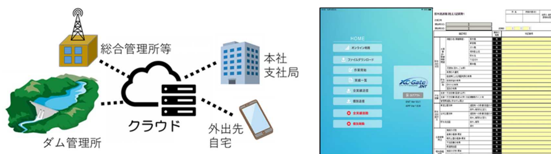
写真－6 XC-Gateによるクラウドへの管理データの蓄積と管理
