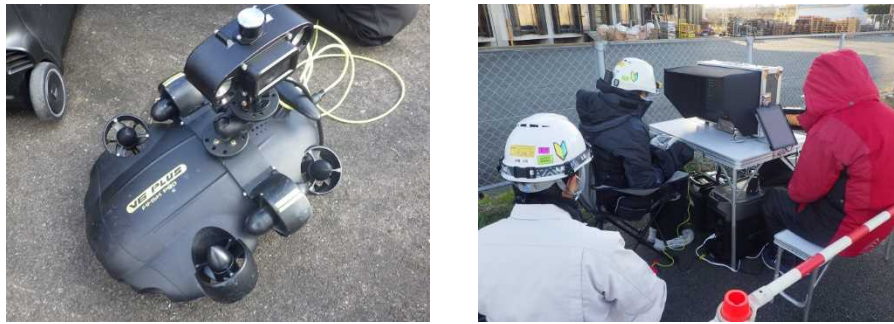
(左：水中ドローン本体、右：水中ドローン操作状況)
