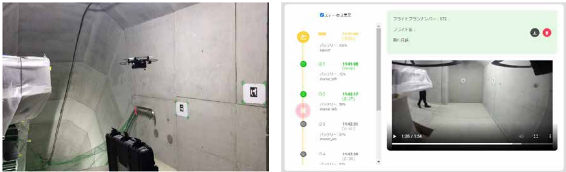
写真-7 自律飛行UAVによる監査廊点検の自動化（デモンストレーション）
