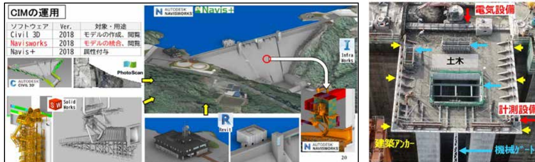
図-2 川上ダムの施工CIMの活用（左：統合したCIMの構築、右：取水塔頂部の施工）
