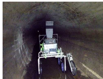
写真－2 山岳トンネルの耐震性能照査と内面調査の実証試験の例（豊川用水）
