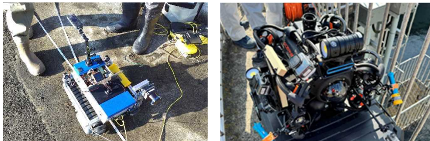
写真－1 左：自走式ロボットによる不可視箇所の診断調査（群馬用水） 右：水中ドローンによる断水調査状況（筑後川下流用水）
