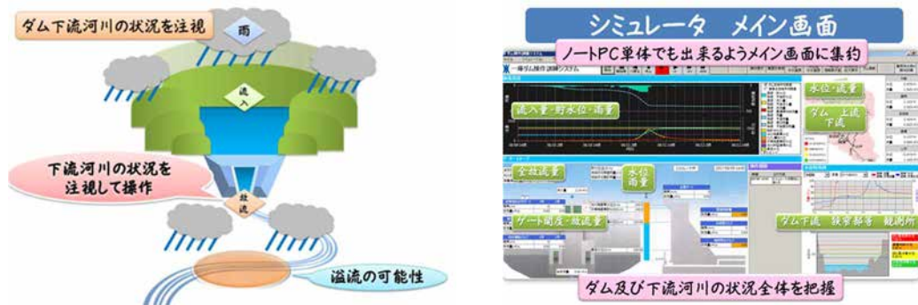
図-2 ダム操作訓練シミュレータ概念図
