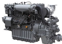
② 漁船用エンジン （船内機）
