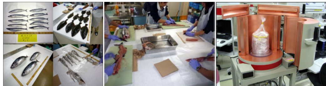
ゲルマニウム半導体 検出器による放射性物 質分析
