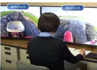
自動走行トラクタの遠隔監視
