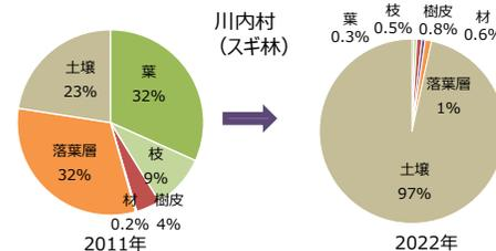
樹木に沈着した放射性セシウムは雨による溶脱や落葉などで地表へ移動し、森林内の分布は11年間で大きく変化。
