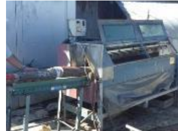
放射性物質の防除施設（ほだ木洗浄機械等）の整備
