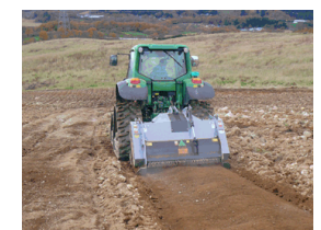
ストーンクラッシャーによる石礫破碎
