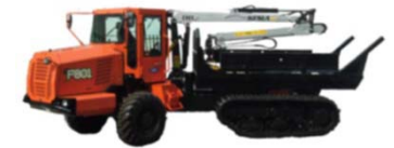
キャビン付フォワーダ (木材運搬車両)
