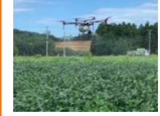
小水量除草剤散布
