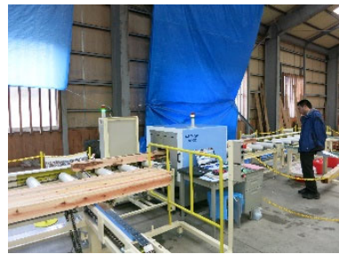
製材品等ライン用検知装置
