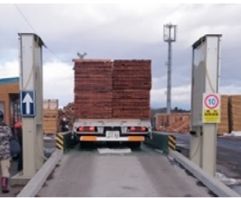
トラックスケール用検知装置
