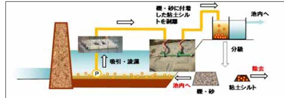
水中の底質を吸引後、エジェクターにて底質の細粒分を剥離し、さらにふるい分け・凝集沈殿により細粒分のみを取り出して回収する。放射性セシウム濃度の低い粗粒分は、池敷に戻す。
